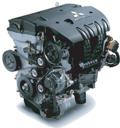
Рис. 1 Новый четырехцилиндровый двигатель MIVEC (4B12)
