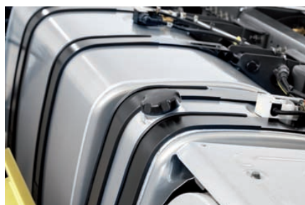
Бак с реагентом AdBlue, установленный рядом с обычным топливным баком.
