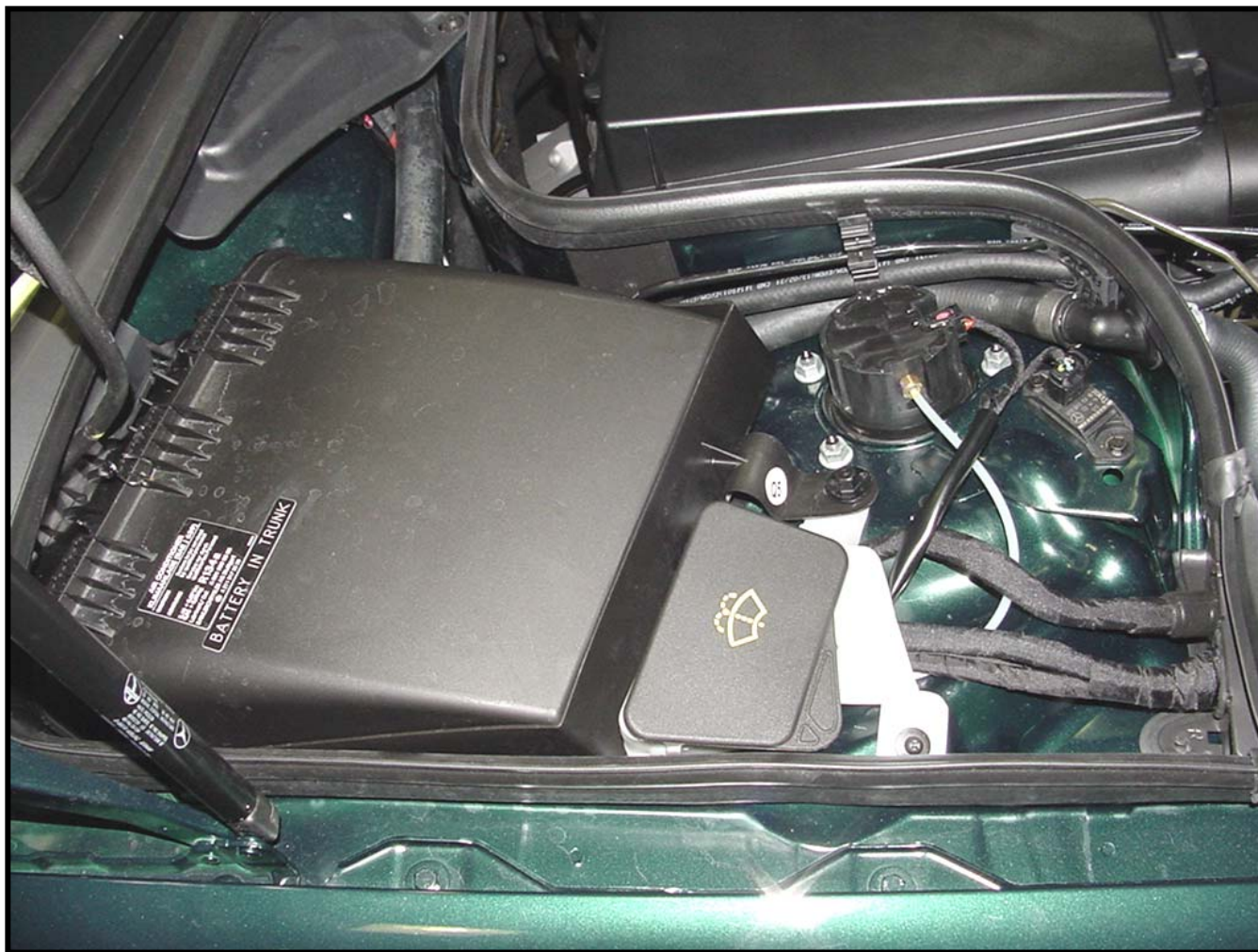
Вспомогательная батарея установлена ниже воздухозаборника системы ОВКВ.
