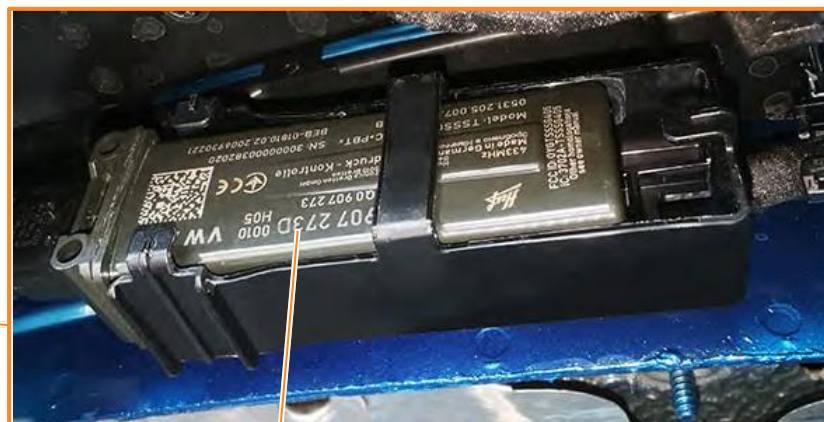
Блок управления контроля давления в шинах J502 с антенной контроля давления в шинах R175
