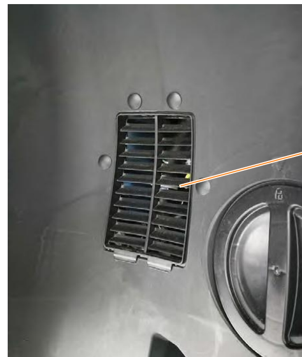
Вентиляционная решётка для активного охлаждения тормозов на передней оси
