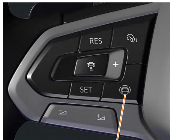
Клавиша меню вспомогательных систем водителя
