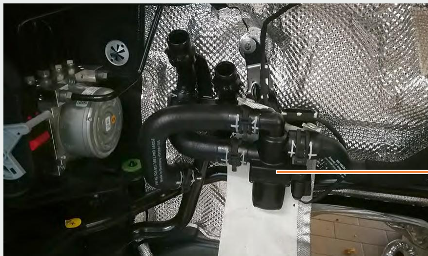
Запорный клапан ОЖ отопителя N279
