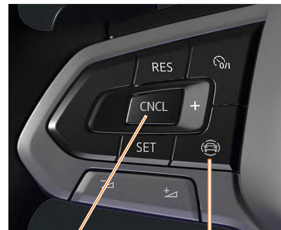
Клавиша CNCL Клавиша меню вспомогательных систем водителя
