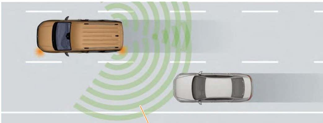
Зона действия задних радарных датчиков
