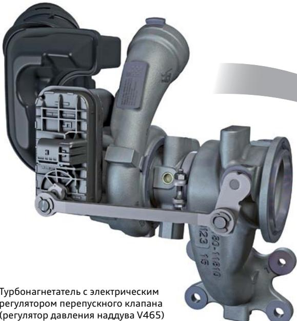
Турбонагнетатель с электрическим регулятором перепускного клапана (регулятор давления наддува V465)
