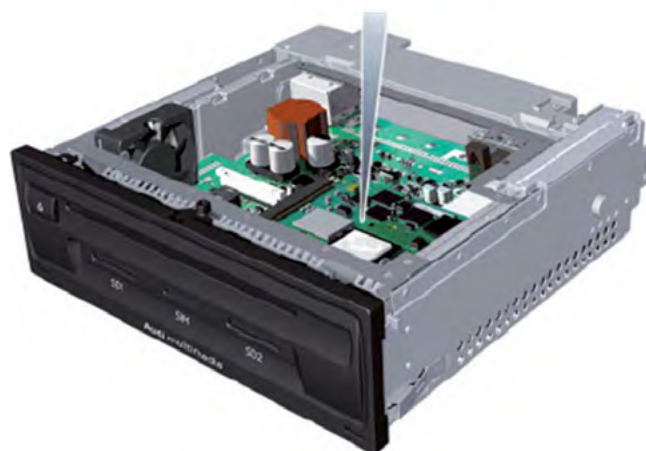
Блок управления информационной электронной системы 1 J794 со встроенной SIM-картой
