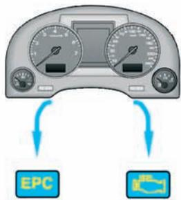
Блок управления комбинации приборов J285 с контрольной лампой электропривода акселератора K132 и лампы check engine K83
