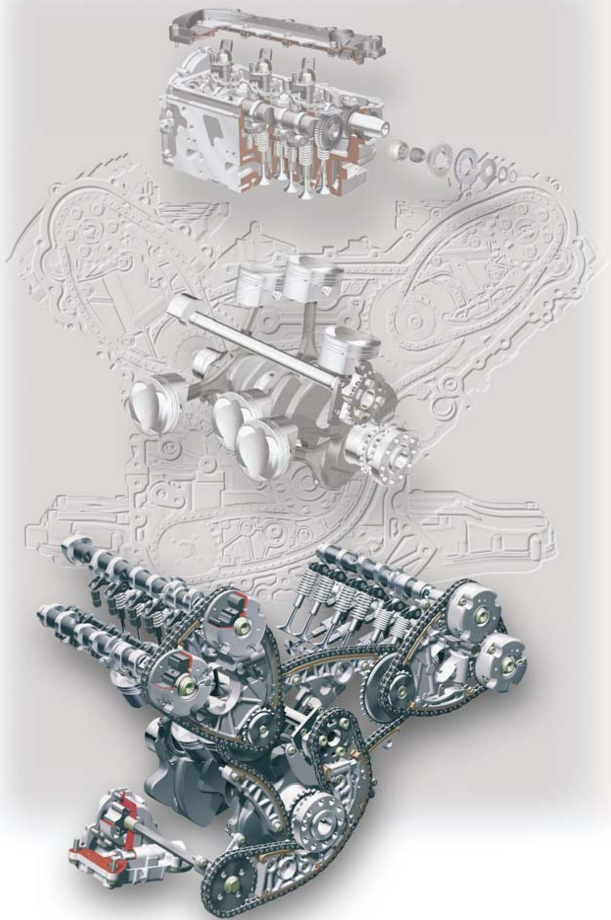
Благодаря расположению цепных передач со стороны маховика и разнесению четырех цепей на две плоскости удастся существенно повысить компактность двигателей. При этом на автомобили малого класса удастся устанавливать многоцилиндровые двигатели, не прибегая к удлинению передней части кузова. Цепные передачи позволяют сократить затраты на техническое обслуживание и ремонт автомобилей, так как они не нуждаются в уходе и рассчитаны на длительные сроки службы.
