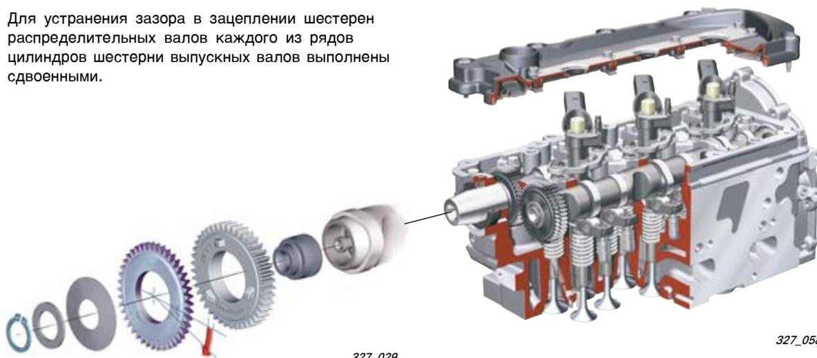
Широкая часть шестерни напрессовывается на распределительный вал в горячем состоянии. Узкая часть шестерни удерживается на распределительном валу стопорным кольцом и прижимается тарельчатой пружиной к широкой части шестерни.
